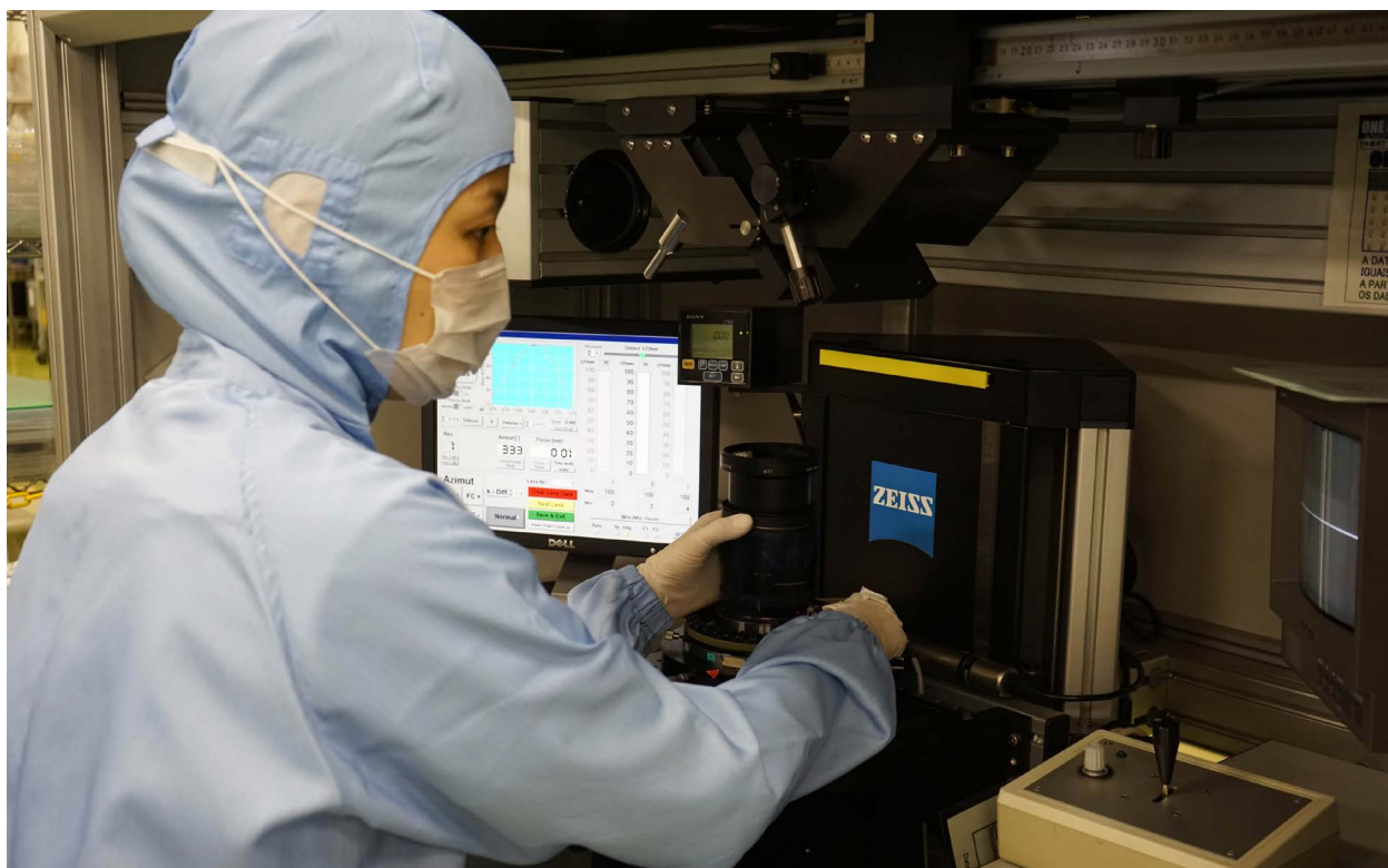
Контроль качества объектива Sony/ZEISS ZA на оборудование ZEISS на заводе Sony.
